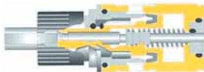
**Kit di manutenzione con guarnizioni Buna-N per il lato ad aria**
